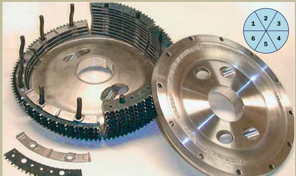
SATURN III AP Convex TURBO Stiftlänge 96 mm Radius 75 mm 36 3/8" AC Distanzstücke 6 3/16" AC Distanzstücke 36 Apollo III Rauklängen 12 Apollo Detreading Rauklängen
